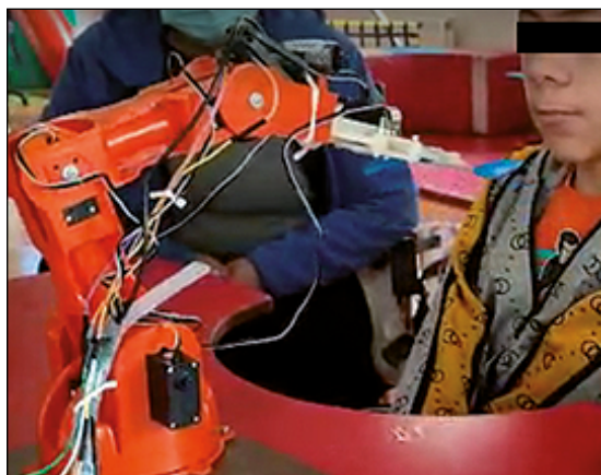
Figura 7. Prototipo brazo robótico N°2 con cámara con inteligencia artificial.
